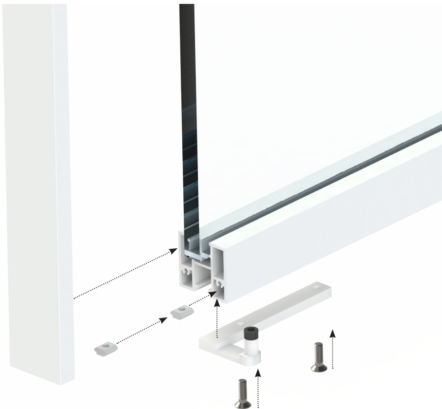
OJO Perfil inferior ya mecanizado Lower profile machined
